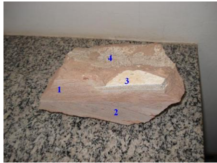
Figura 13 -Rocha utilizada como fonte natural de partículas alfa, os números indicam áreas com características diferentes
