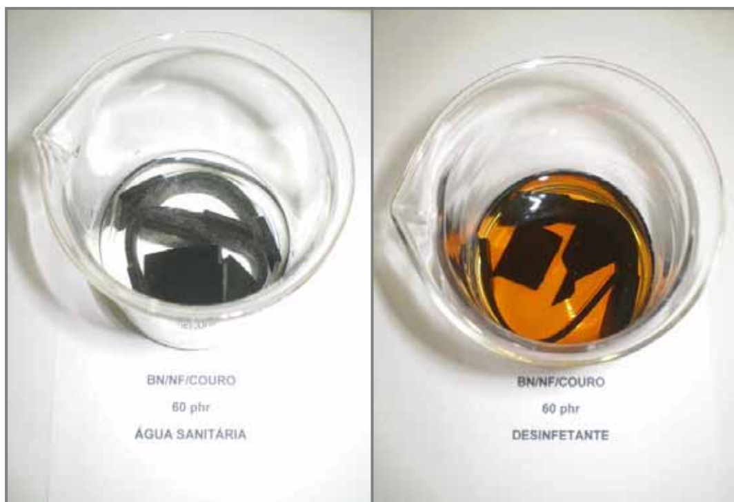
Figura 12: Amostras do compósito BN/NF/Couro 60 phr imersas nos agentes saneantes.
