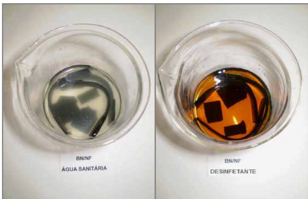
Figura 10: Amostras do compósito BN/NF imersas nos agentes saneantes.
