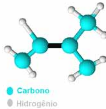
Figura 2: Monômero da cadeia polimérica da borracha natural: unidade repetitiva do poli (cis-1,4 -isopreno).
