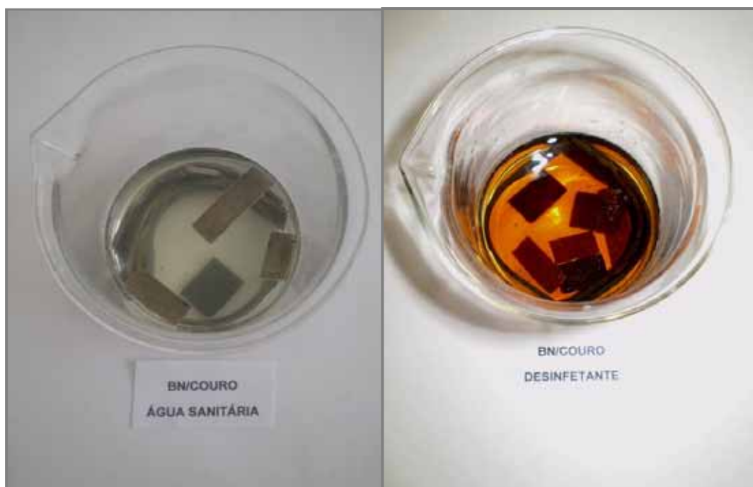
Figura 11: Amostras do compósito BN/Couro imersas nos agentes saneantes.
