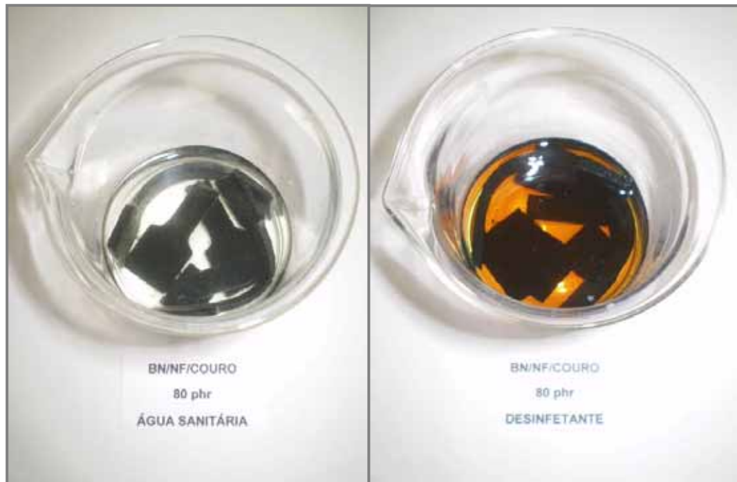
Figura 13: Amostras do compósito BN/NF/Couro 80 phr imersas nos agentes saneantes.
