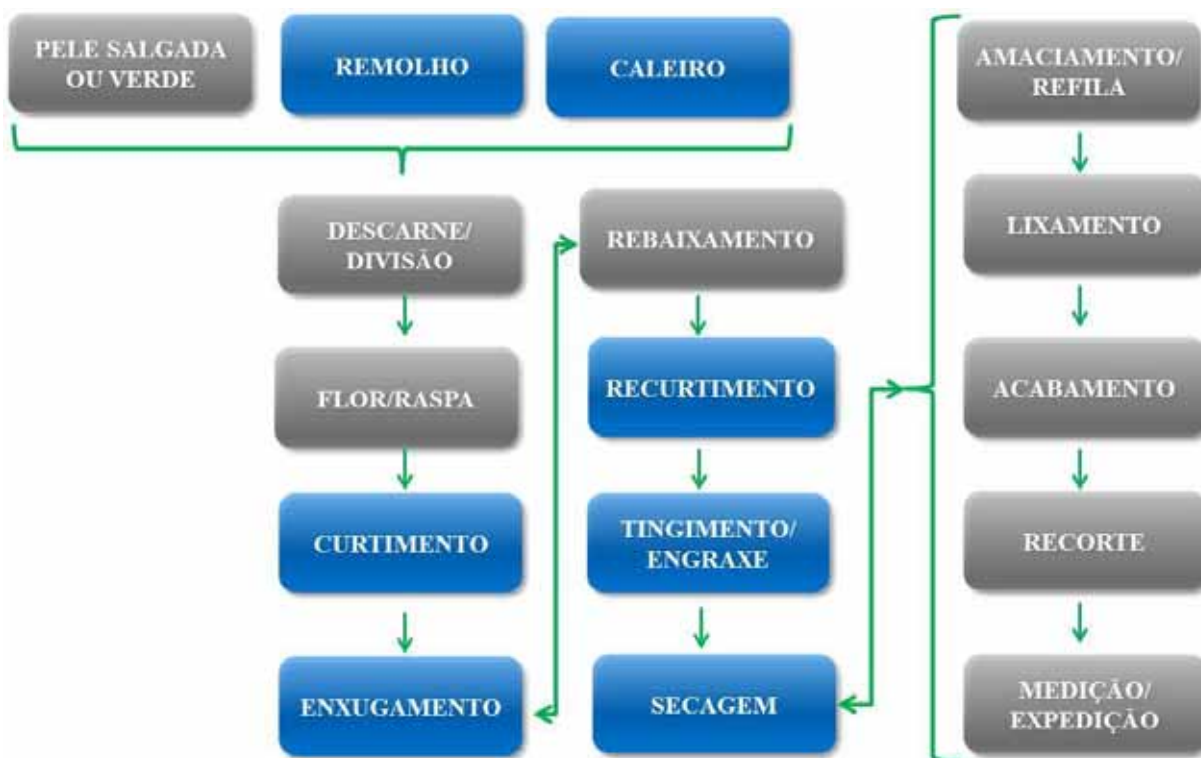
Figura 7: Fluxograma da produção de couros.
