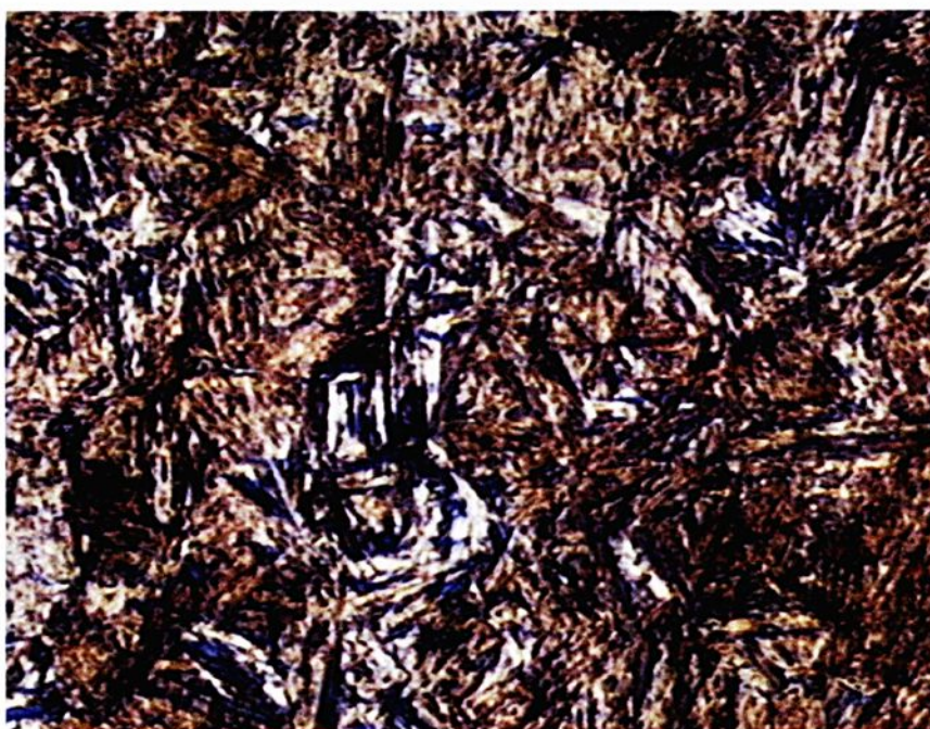
FIGURA 3.3: Fotomicrografia de uma estrutura martensítica (página da MIM/CIM – Metalurgia e Ingeniería de los Materiales/Ciência de los Materiales e Ingeniería Metalúrgica, Internet, 2004)
