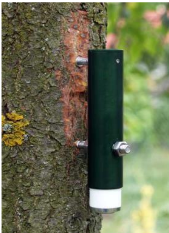
Figura 2 – Dendrômetro automático Tomst
