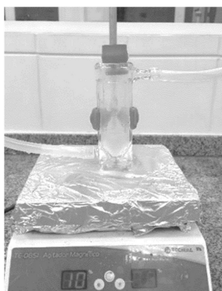
Figura 10. Sistema de reação na análise da posição sn-2. Fonte: elaborado pela autora.
