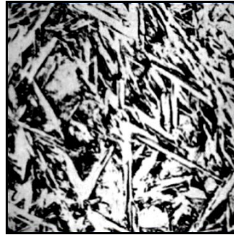
Figura 3- Microestrutura Martensita (Aço Carbono de médio Teor, atacada 1000x).
