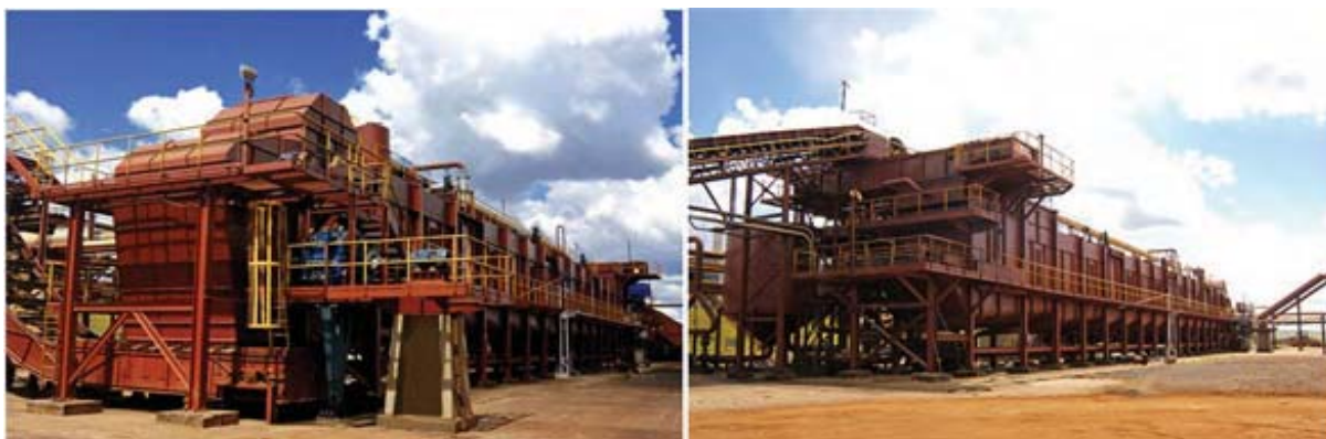
Figura 2.11: Difusor da Usina Cevasa com capacidade de 6.000 t de cana por dia. (Fonte: UNI-SYSTEMS).
