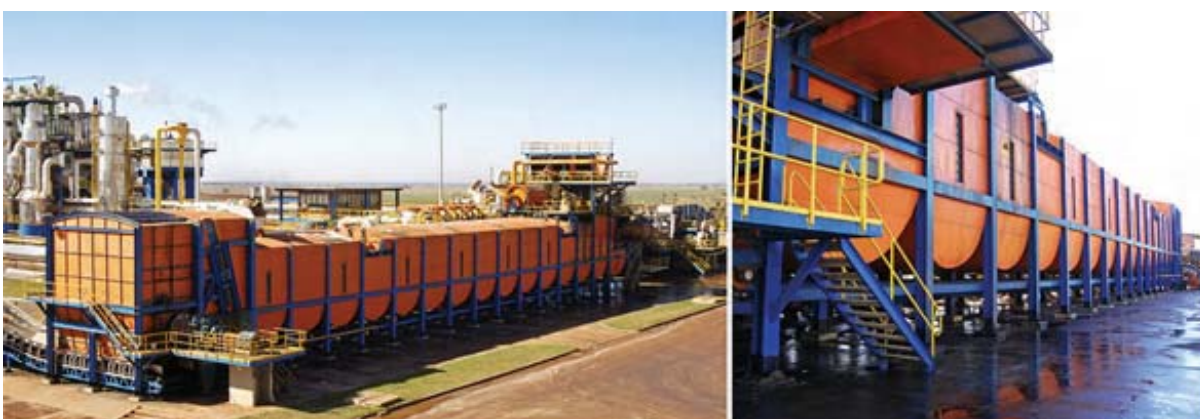
Figura 2.12: Difusor da Usina Vale do Paranaíba com capacidade de 8.000 t de cana por dia. (Fonte: UNI-SYSTEMS).
