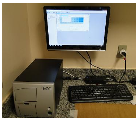
36. Leitor de microplacas acoplado ao computador para obtenção dos valores de cálcio
