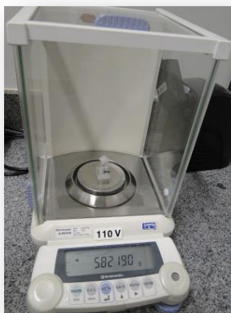
19. Pesagem do conjunto após a coleta do biofilme na balança de 5 casas (Shimadzu)
