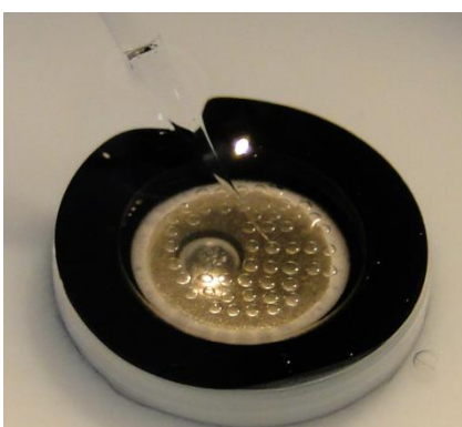
29. Análise com eletrodo invertido e o fechamento do circuito com o eletrodo de referência (leitura das amostras de saliva e biofilme total quanto ao F).
