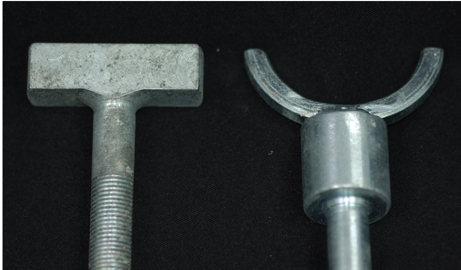
Figura 6 - Haste para aplicação de força durante o ensaio de carregamento
