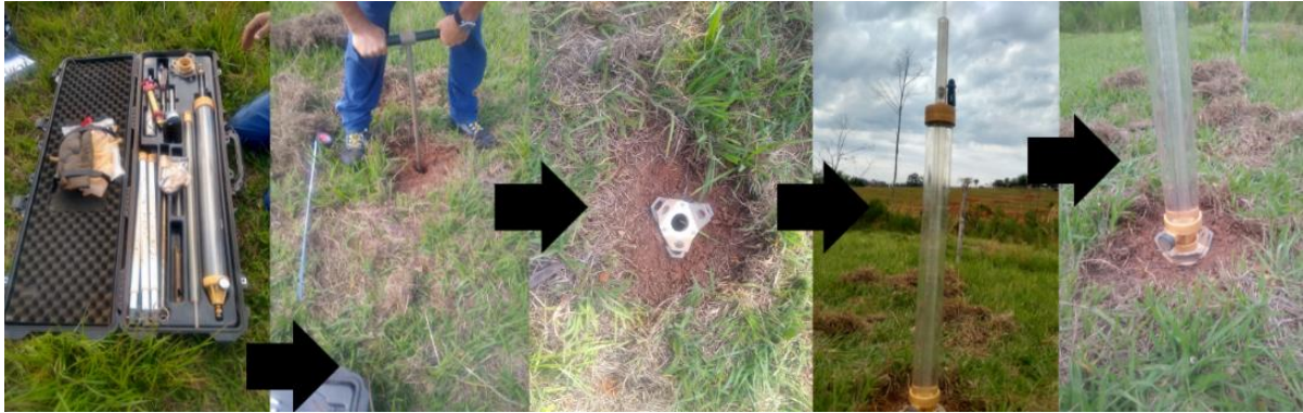
Figura 15 – Exemplificação dos procedimentos em campo de análise da permeabilidade do solo.
