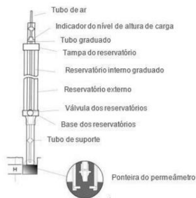
Figura 14 - Estrutura do Permeâmetro Guelph.
