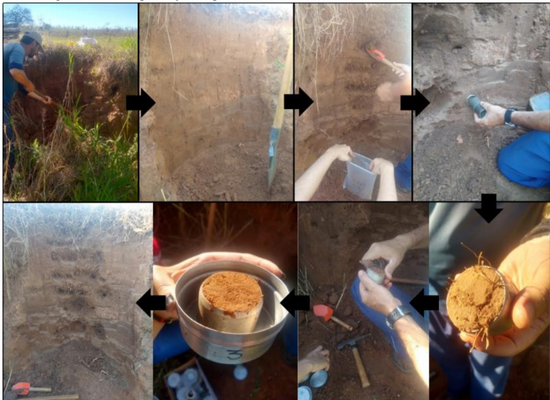
Figura 16 – Exemplificação do procedimento de coleta de amostras e anel volumétrico.
