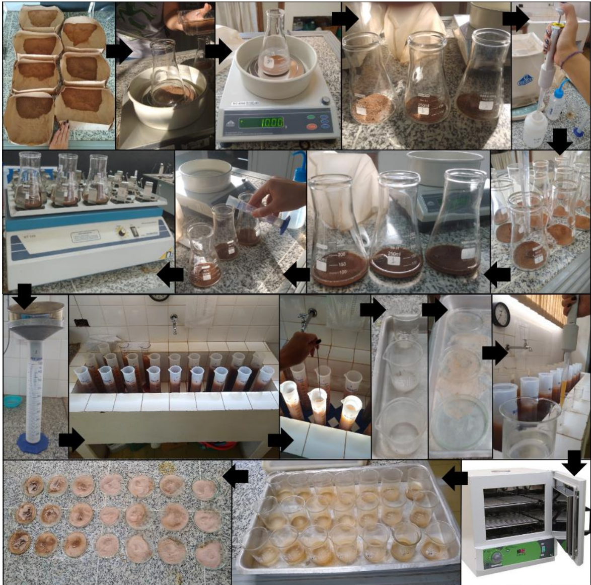
Figura 17 – Exemplificação dos procedimentos laboratoriais de análise granulométrica.
