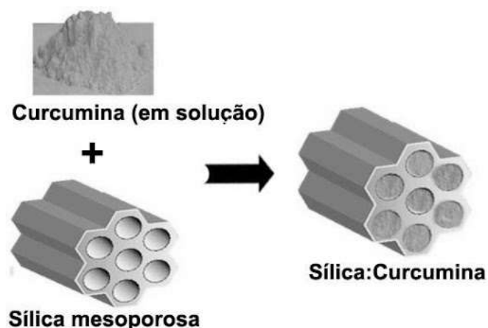
Figura 4.1: Diagrama ilustrativo da incorporação da curcumina na sílica mesoporosa SBA-15.
