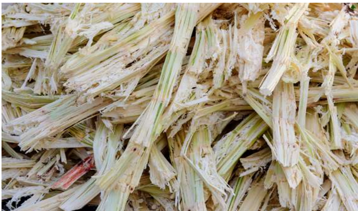
Figura 4. Bagaço da cana-de-açúcar obtido após processo de moagem
