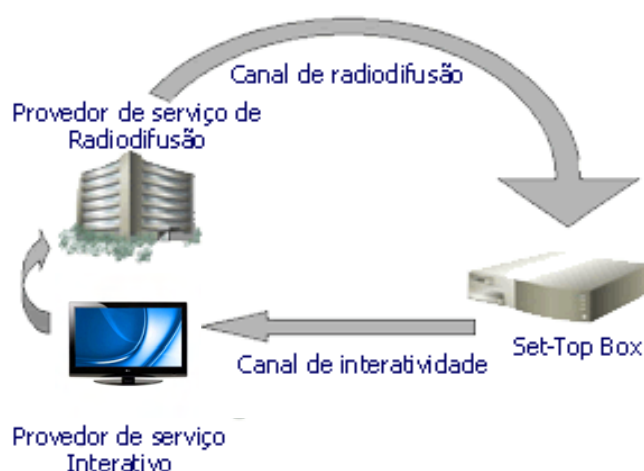
Figura 1: Esquema de Comunicação de um Sistema de TV Digital (Adaptado de www.teleco.com.br )
