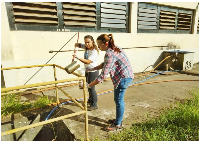
Figura 3 – Coleta de efluente da ETE Toledos I.
