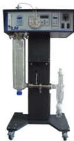
Figura 10. Secador spray dryer utilizado para a modificação física do amido. Fonte: Labmaq do Brasil, disponível em: http://www.labmaq.com.br/home/index.php .
