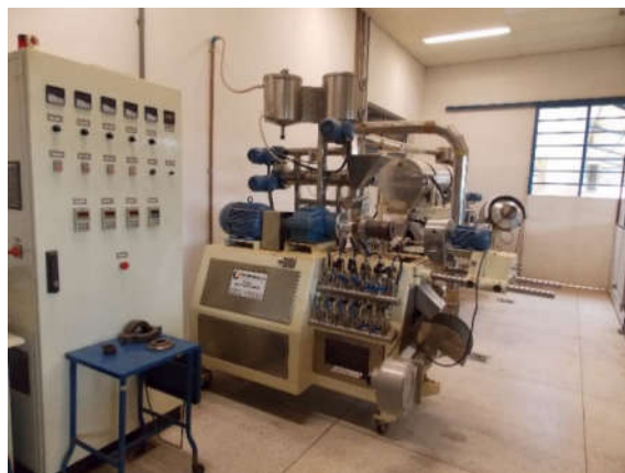
Figura 12. Linha completa de extrusão INBRA RX da Inbramaq S/A no laboratório de processo do CERAT/UNESP.
