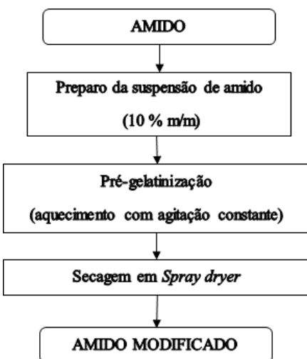
Figura 9. Fluxograma do processo de modificação spray drying . Fonte: Fluxograma de Thaís Paes Rodrigues dos Santos.
