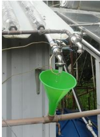
FIGURA 2 – Sensor Termopar no Fluxo de Água Proveniente do Aquecedor Solar.
