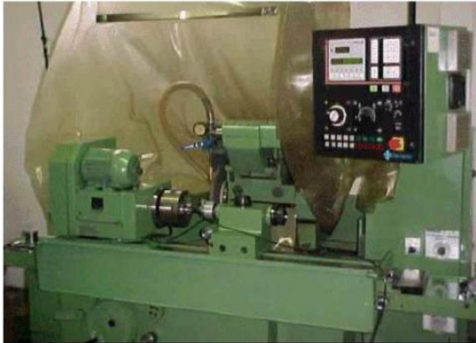
Figura 18: Retificadora cilíndrica CNC Sulmecânica - RUAP 515 H Laboratório de Usinagem por Abrasão (LUA)
