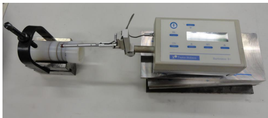
Figura 23: Rugosímetro e suporte utilizados para medir a rugosidade das peças.
