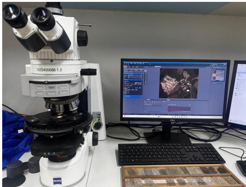
Figura 9 - Microscópio óptico ZEISS Axio Imager.A2 com câmera acoplada, utilizado para estudo petrográfico e fotomicrografia das lâminas delgadas.
