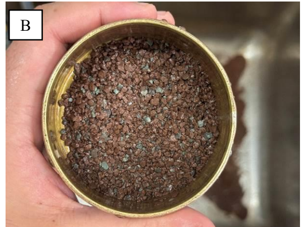
Figura 8 - A) A esquerda, béquer utilizado para retenção dos finos a serem descartados, a direita, peneira de 1 mm utilizada para o peneiramento das amostras. B) Amostra já lavada com água deionizada, para remoção dos torrões de argila. C) Ultrassom utilizado para desagregação das argilas na superfície dos fragmentos. D) Secagem do material em estufa a 40°C. E) Triagem do material para remoção de possíveis contaminantes. F) Almofariz de ágata utilizado para a pulverização das amostras.
