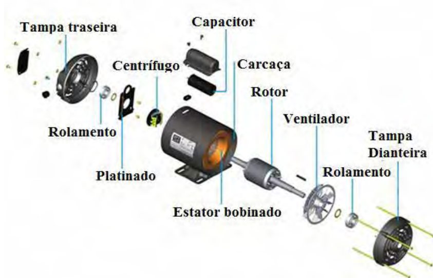
Figura 2 - Visão explodida do motor monofásico ( www.weg.com.br ).
