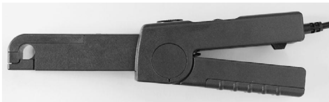
Figura 32 - Ponta de corrente de efeito Hall modelo A622 da empresa Tektronix ( www.tektronix.com ).
