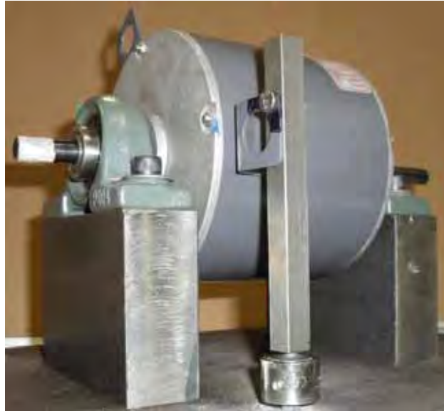
Figura 30 - Ligação entre a carcaça do motor e a célula transdutor de força (o autor).
