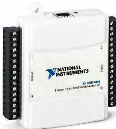
Figura 27 - Placa de aquisição de dados modelo NI-DAQ6009 utilizada nos ensaios (sine.ni.com).
