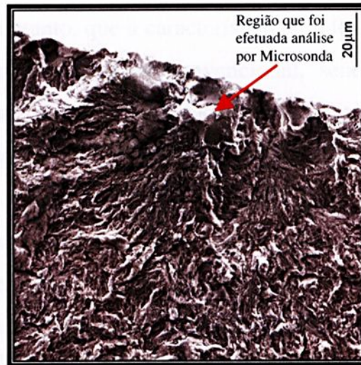
Figura 4.23. Região de início de fratura para material ESR, mostrando a pequena zona de propagação de trinca e o começo da zona de ruptura. 1000 vezes.
