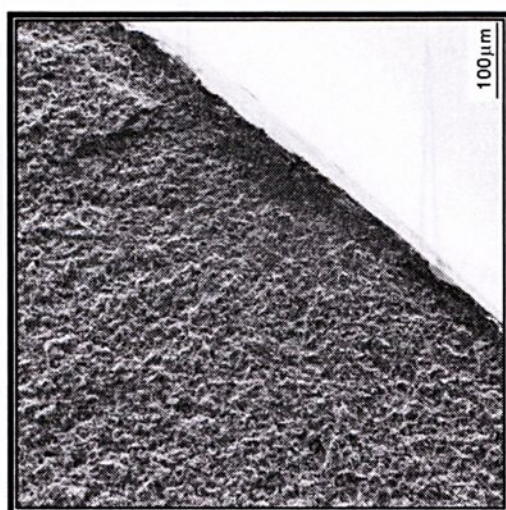
Figura 4.18. Fractografia da região de início de fratura do CDP de flexão. 200 vezes
