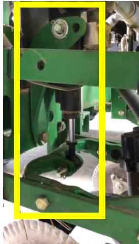
Figura 2. Sistema de força descendente hidráulico em linha instalado na unidade de semeadura.
