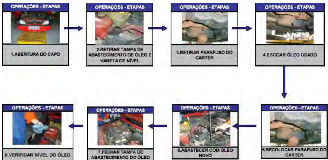
Figura 16: Fluxograma das Etapas de Troca de Óleo Lubrificante
