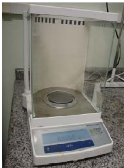
Figura 3.5. Balança analítica da marca Mettler Toledo, modelo AB 204-S.
