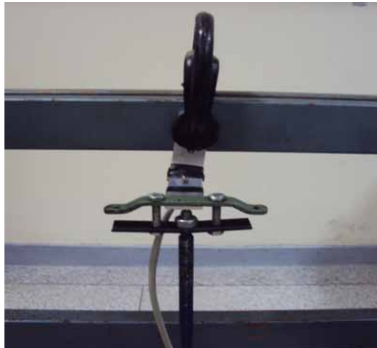
Figura 18 – Foto ampliada da calibração do sistema Viga-Transdutor.
