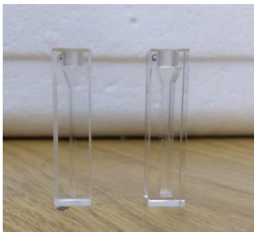
Figura 12 – Cubetas de quartzo com 2 e 4 mm de caminho acústico.
