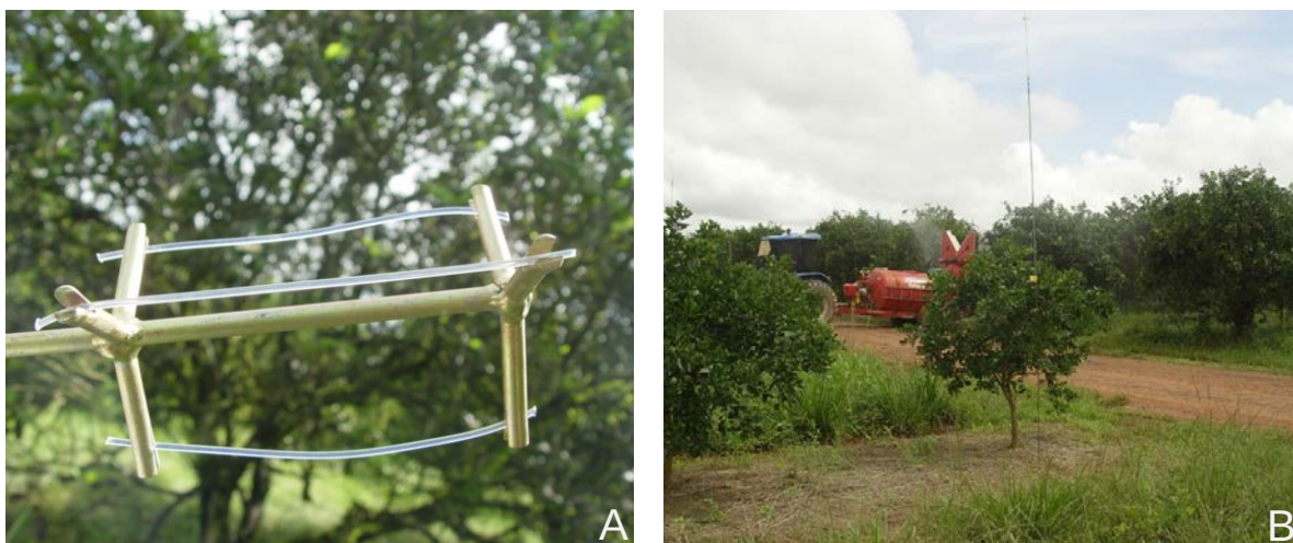
Figura 3. A - Detalhe do suporte apical para três fios de náilon (com os fios amostradores). B – Haste coletora posicionada na área adjacente no pomar de laranja durante a pulverização fitossanitária (Capitão-Poço, 2014).
