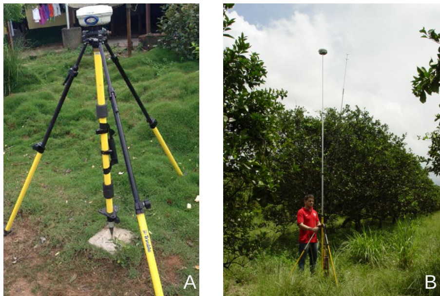
Figura 5. A – Base Fixa do Sistemas de Navegação Global por Satélites (GNSS) instalada em um marco geodésico localizado na sede da propriedade. B - Base móvel (Rover) do Sistemas de Navegação Global por Satélites (GNSS) rastreando a posição espacial dos coletores de deriva na área experimental. Capitão-Poço, 2014.
