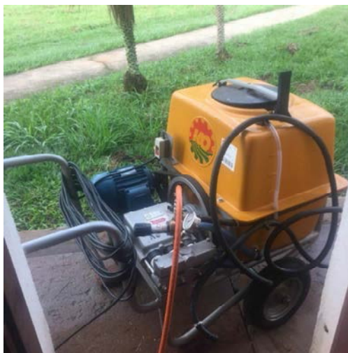
Figura 1. Pulverizador semi-estacionário motorizado experimental K.O., utilizado para pressurizar as caldas nas avaliações de diâmetro de gotas com pontas de pulverização de jato cônico. Jaboticabal, 2015.
