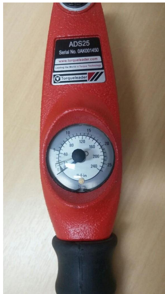
Figura 5 – Leitor do torquímetro com relógio
