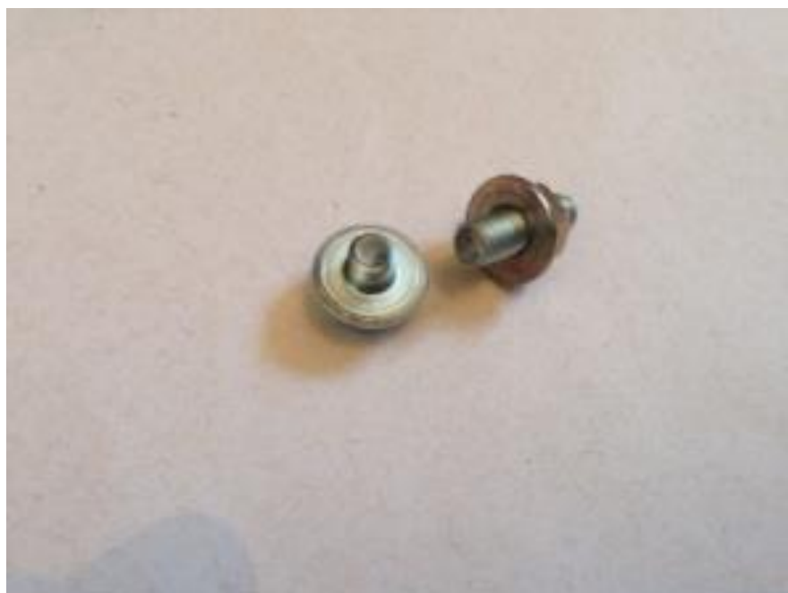
Figura 9- Parafuso flangeado com porca flangeada sem lubrificação após aplicação de torque próximo de 30,0 N.m.
