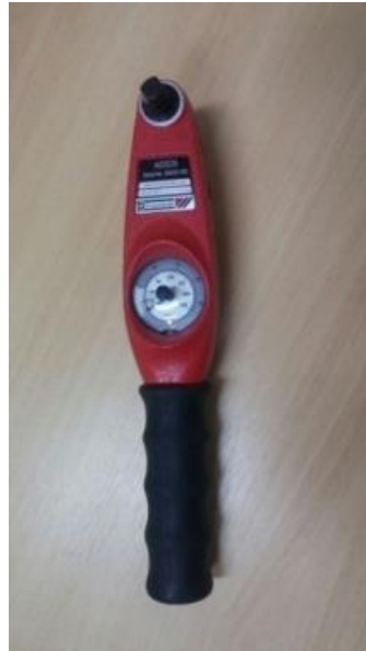
Figura 4 - Torquímetro com relógio e ponteiro de arraste
