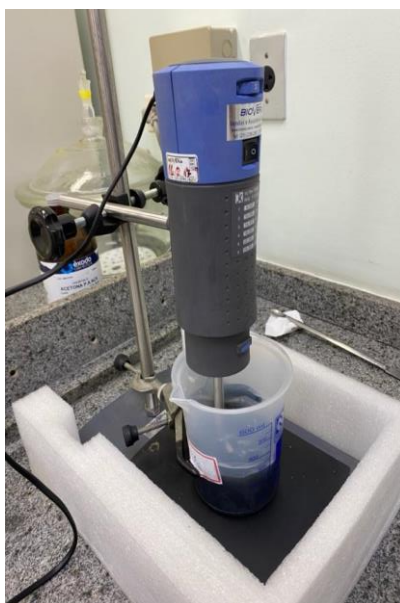
Figura 8 - Uso do dispersor de alto cisalhamento para processamento do filme de PEI/GNP.
