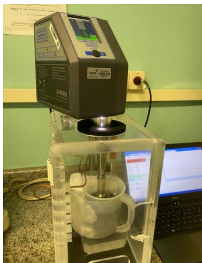
Figura 7 - Uso da ponteira ultrassônica para processamento do filme de PEI/GNP.
