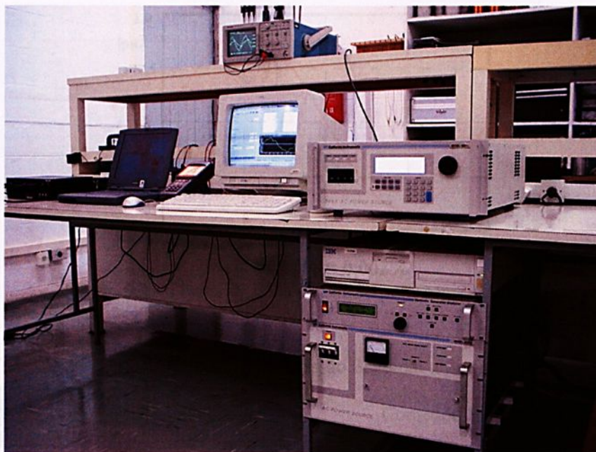
Figura 5.1 – Visão do laboratório de testes, com os equipamentos utilizados nos ensaios. Em baixo, a Fonte de Tensão Ideal da California Instruments ; e, acima, o Osciloscópio Tektronix .
