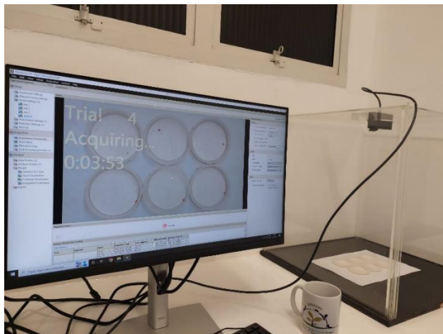
Figura 5. Avaliação do efeito comportamental dos óleos essenciais sobre Zabrotes subfasciatus com a utilização do software de rastreamento de vídeo automatizado acoplado a uma câmera.
