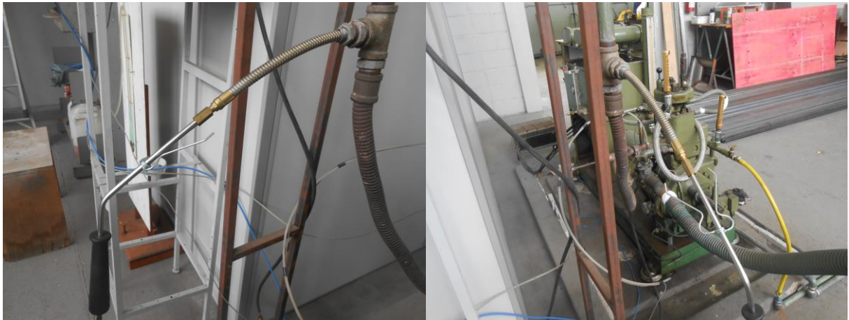
Figura 22. Montagem da sonda coletora de gases no cano de escapamento.
