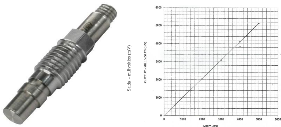
Figura 2. (a) Sensor de pressão PCB 113B22; (b) Curva de calibração sensor de pressão.
