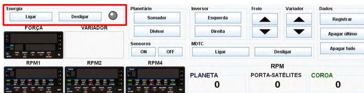
Figura 66. Controles utilizados para ligar ou desligar a alimentação energética do simulador e indicação de quando o simulador está alimentado.
