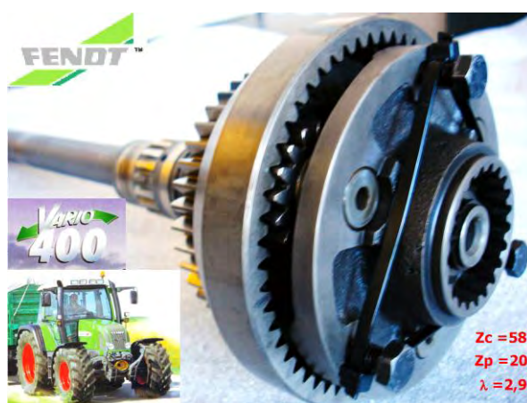
Figura 32. Sistema planetário utilizado na composição da maquete.
