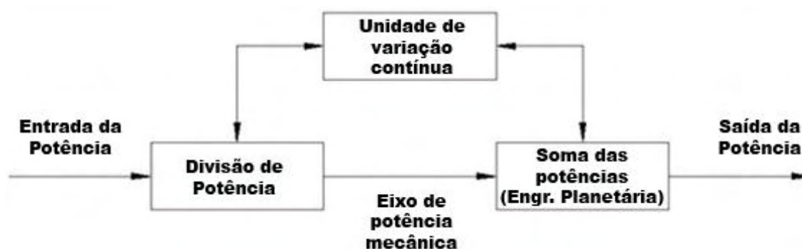
Figura 8. Princípio da Transmissão de variação contínua com divisão de potência (Fonte: Sun, 2011).
