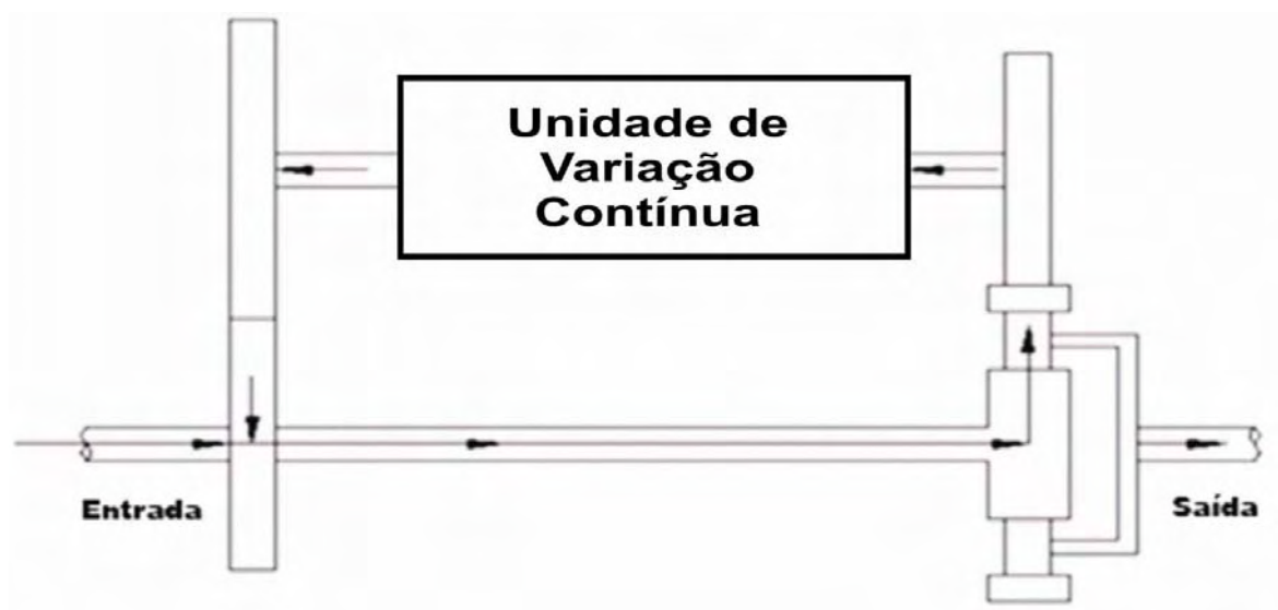
Figura 14. Sistema planetário somador regenerativo (Fonte: Sun, 2011).
