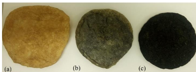
Figura 26: Amostras secas obtidas da coagulação de (a) BN, (b) BN/NLG15 e (c) BNP/NLG15.
