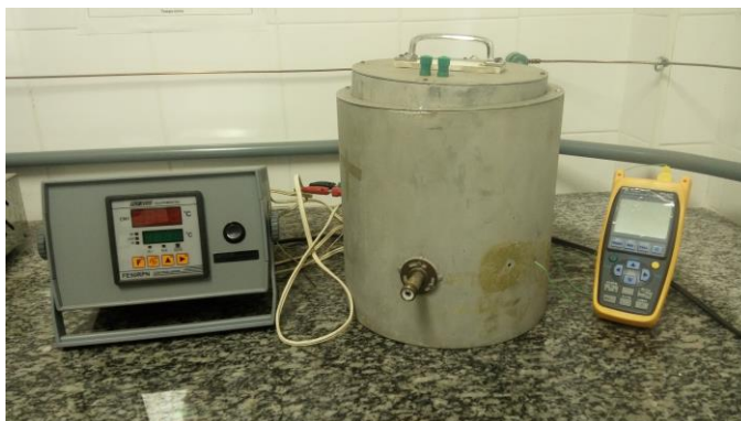
Figura 29: Sistema utilizado para envelhecimento térmico das amostras.
