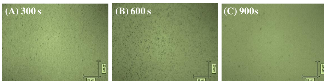
Figura 13: imagens de microscopia óptica dos filmes de Ni-Salpn eletrodepositados a +1,2 V vs. Ag/AgCl por (A) 300, (B) 600 e (C) 900 s. Microscópio óptico acoplado ao espectrômetro micro-Raman. Lente objetiva 50X levando a um aumento total de 500X.
