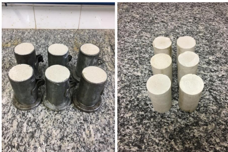
Figura 14 - Corpos de prova cilíndricos para ensaio de resistência à compressão axial.
