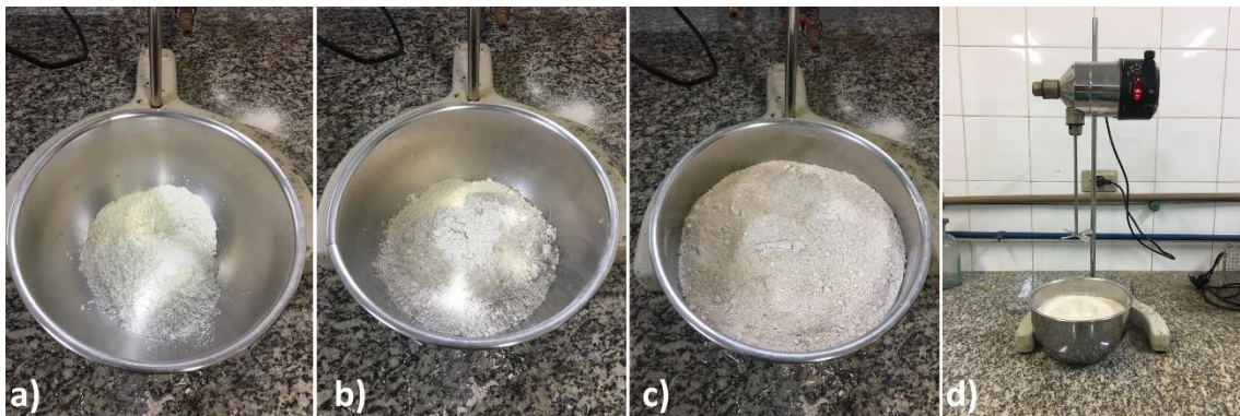
Figura 11 - Preparação da argamassa. a) Cimento; b) Cimento + Cal; c) Cimento + Cal + Areia; d) Cimento + Cal + Areia + Água.
