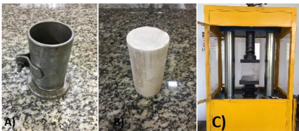
Figura 9 – A) Molde metálico, B) Corpos de prova para ensaio de compressão axial e C) Prensa hidráulica para rompimento dos CPs.
