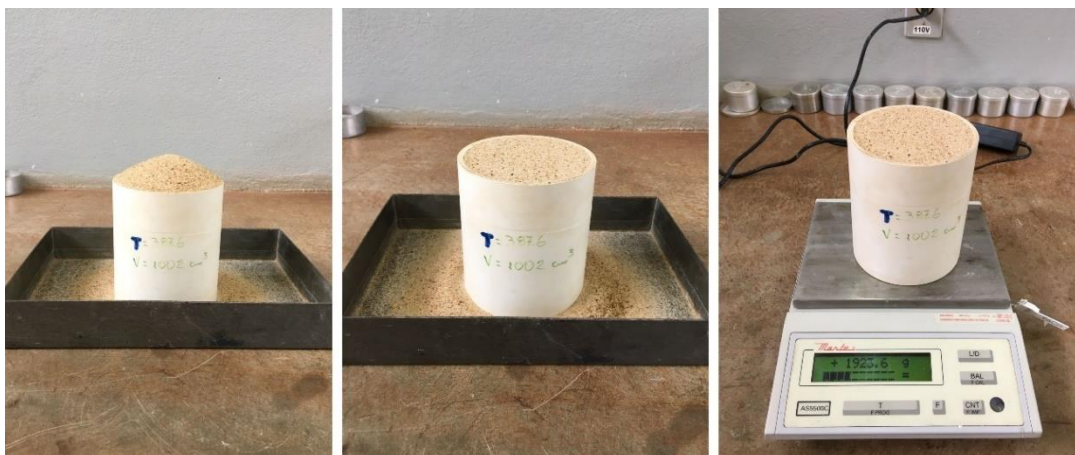
Figura 7 - Determinação da massa unitária em estado solto e compactado do agregado miúdo.
