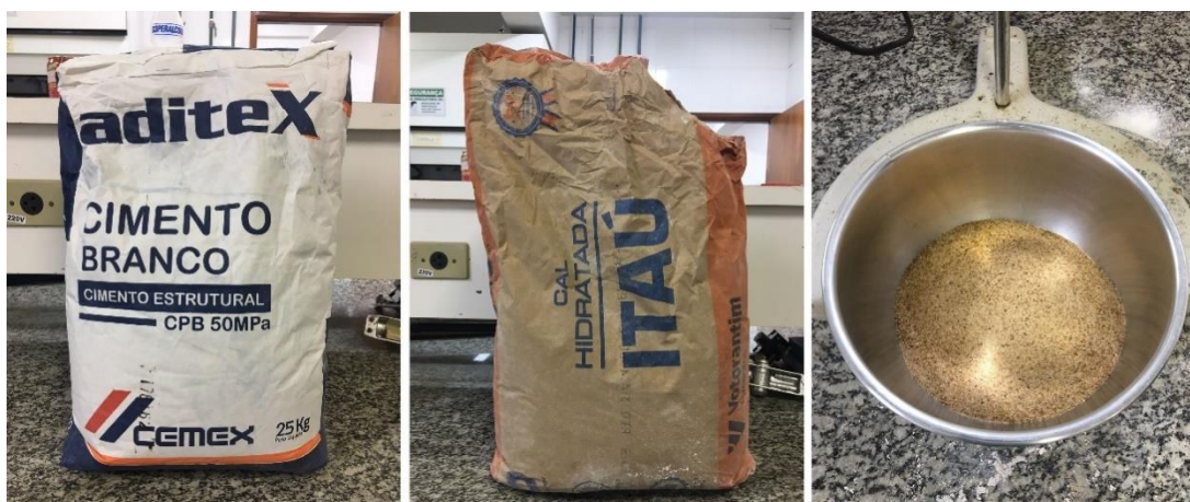
Figura 10 - Materiais utilizados para a confecção da argamassa.
