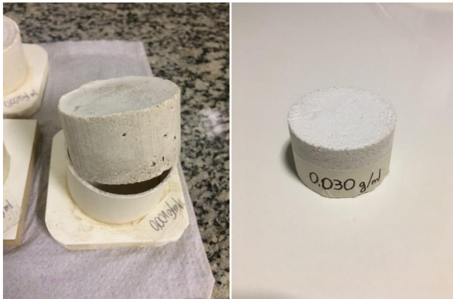
Figura 13 - Corpo de prova de argamassa branco pronto para utilização.
