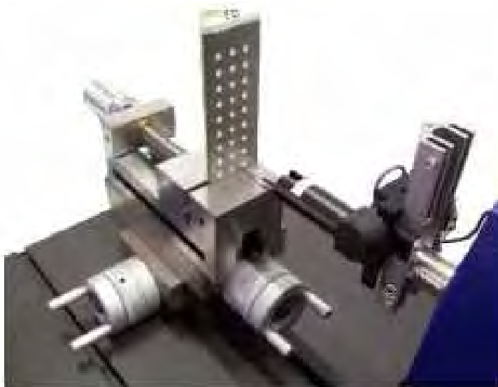
Figura 44 – Metodologia de medição da rugosidade.
