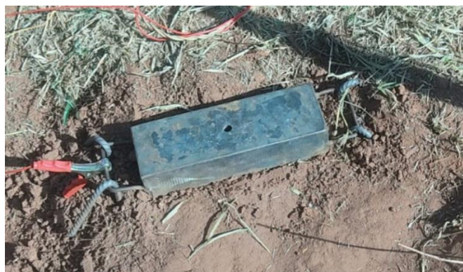
Figura 19: Fonte sísmica fixa ao solo com o uso de ganchos. Fonte: Autoria própria.
