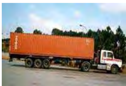
Figura 7: Cavalos pesados com carroceria de contêiner utilizado no transporte de cargas unitizadas.
