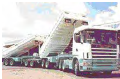
Figura 11: Respectivamente, carroceria canaveira treminhão e carroceria rodotrem.
