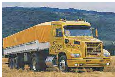
Figura 8: Cavalos pesados com carroceria graneleira utilizado no transporte de cargas unitizadas ou granel.
