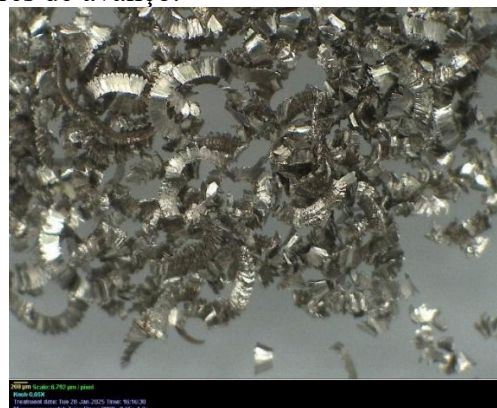
f = 0,2 mm/rev. Cavaco helicoidal curto
