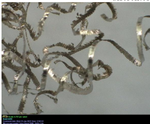
f = 0,1 mm/rev. Cavaco helicoidal longo
