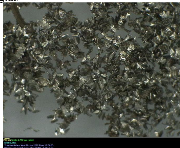
a_p = 0,2 mm. Cavaco fragmentado
