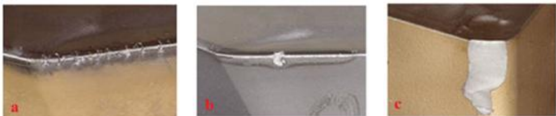
Figura 16 – Avarias na ferramenta: (a) trincas térmicas, (b) lascamentos, (c) quebra.
