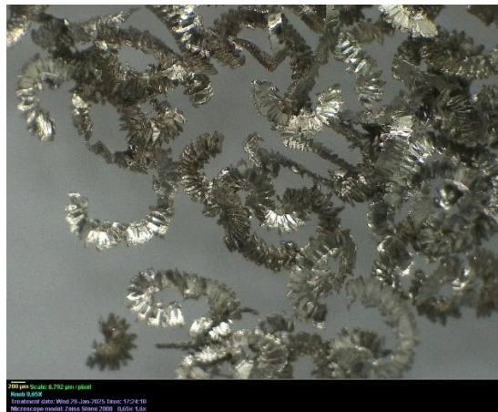
a_p = 0,2\text{mm} . cavaco helicoidal curto
