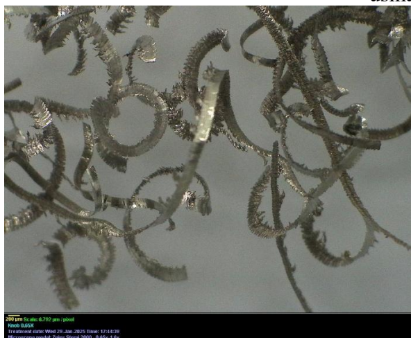
a_p = 0,1 mm. Cavaco helicoidal longo
