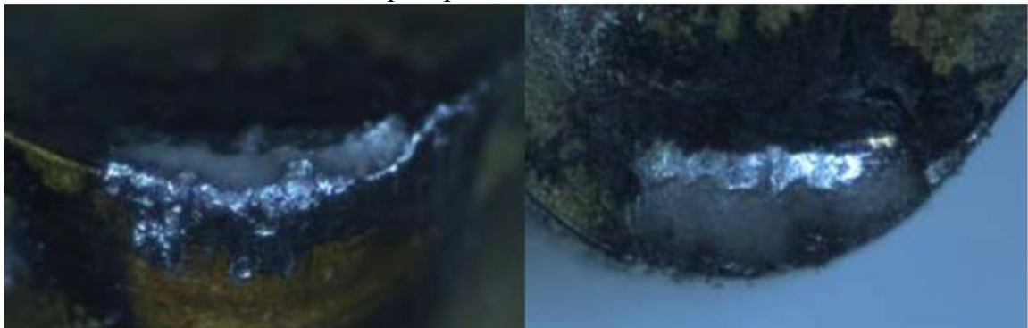
Figura 24 – Desgaste de cratera em ferramenta de metal duro revestido com (TiAl)N+TiN pelo processo de PVD.
