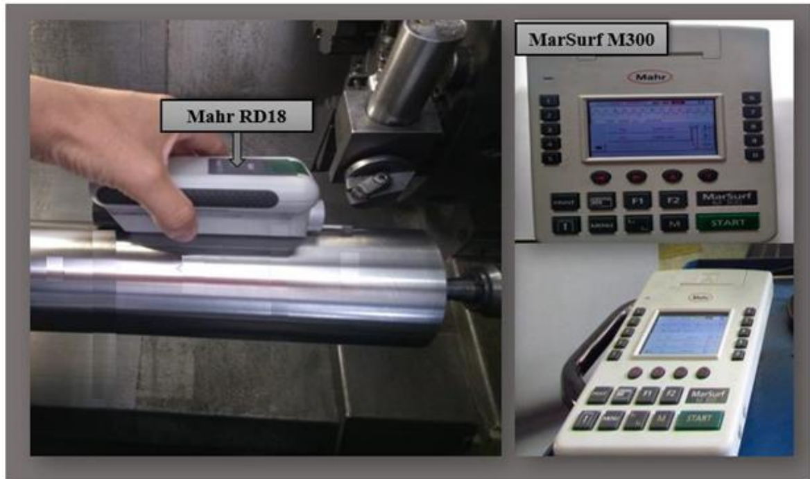
Figura 39 – (a) Medição da rugosidade com rugosímetro portátil MarSurf RD18. (b) O aparelho MarSurf M300. (b)
