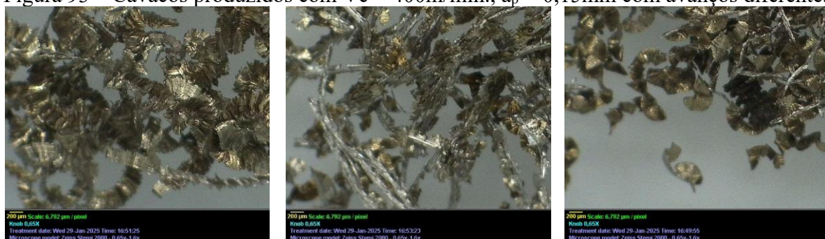
Avanço = 0,15\text{mm/rev.} Cavaco helicoidal curto
