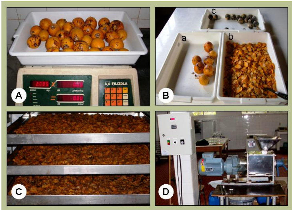
FIGURA 4 - Ilustração das etapas da metodologia: A) Pesagem dos trinta frutos; B) Despoldagem: a- frutos inteiros, b- polpa, c- castanha ou caroço; C) Secagem da polpa em estufa de ventilação forçada; D) Mini Prensa ERCITEC Modelo MPE-40 com adaptação para MTD 5 cv.
