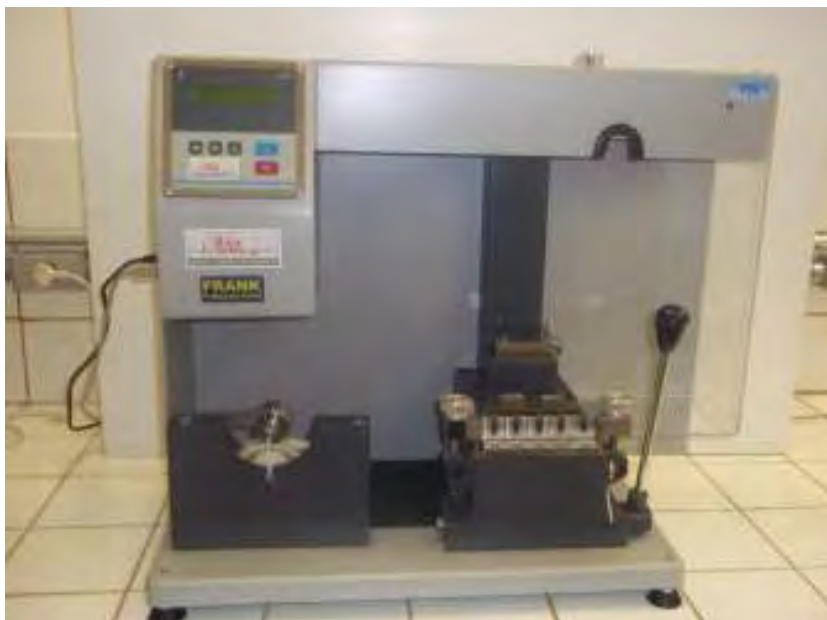
Figura 18 - Aparelho utilizado para medição de resistência interna
