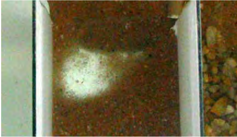
Figura 2: Exemplo do sedimento de 0,12 cm considerado como escavado devido ao aparecimento do vidro.
