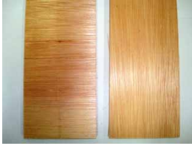
FIGURA 12 – Direção das fibras nos corpos de prova de flexão estática. O da esquerda é perpendicular e o da direita paralelo.
