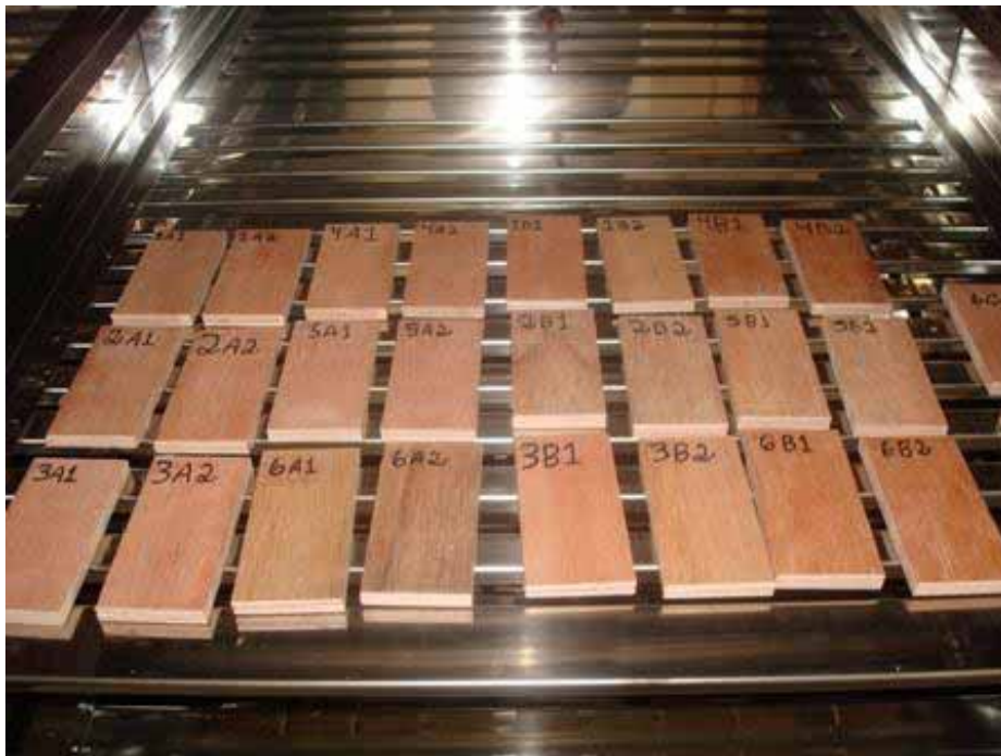
FIGURA 9 – Corpos de prova utilizados para a determinação da massa específica e o teor de umidade na estufa.
