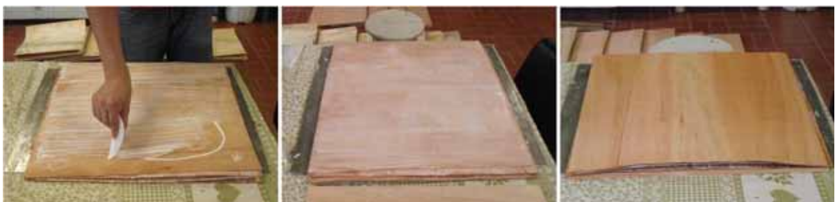
FIGURA 7 – Aplicação do adesivo; (A) aplicação do adesivo com espátula de silicone; (B) adesivo aplicado sobre a lâmina; (C) painel com todas as linhas de cola aplicadas.
