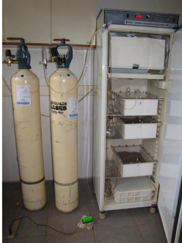
Figura 3: Foto sistema de incubação dos ovos. Do lado esquerdo temos os cilindros com as misturas contendo 3 e 6% de gás carbônico, e do lado direito a câmara de incubação a 30°C.
