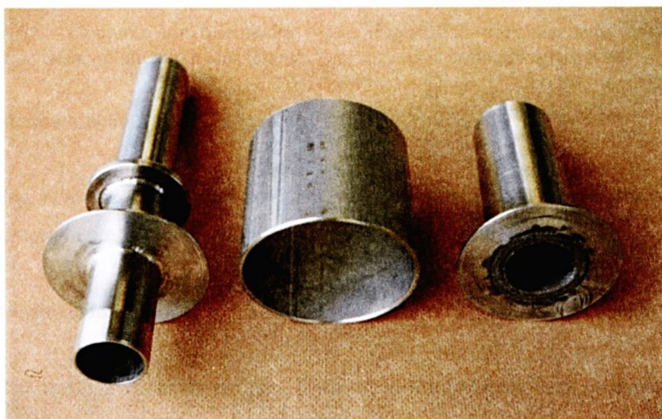
Figura 2.5 – Componentes da câmara de desacoplamento.
