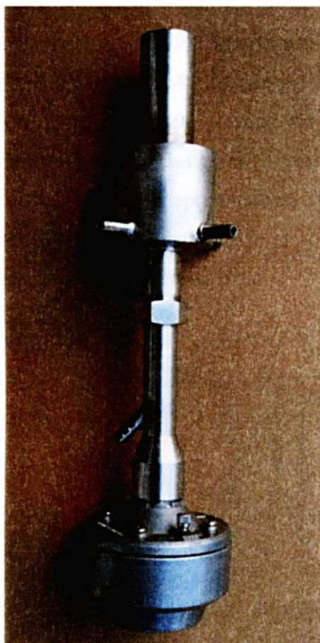
Figura 2.6 – Conjunto com queimador, câmara de desacoplamento e alto falante.
