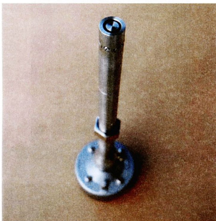
Figura 2.3 – O queimador com o alto falante em sua base.
