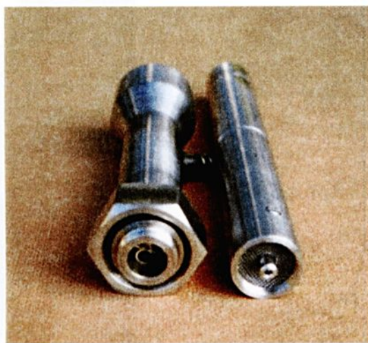
Figura 2.4 – Detalhes internos do queimador.
