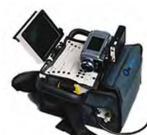
Figura 23 - Detector de radiação ultravioleta, DAYCOR II , com câmera de filmagem SONY.
