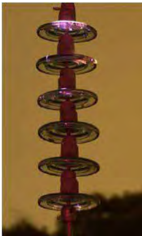
Figura 9 - Efeito das descargas superficiais em uma cadeia de isoladores (BOLOGNA, F. F. et al, http://www.corocam.com/papers.asp , acesso em 20/12/2006).
