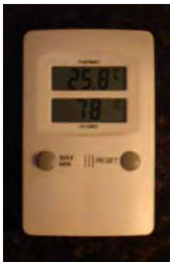
Figura 25 – Termo-higrômetro para medição de temperatura e umidade.
