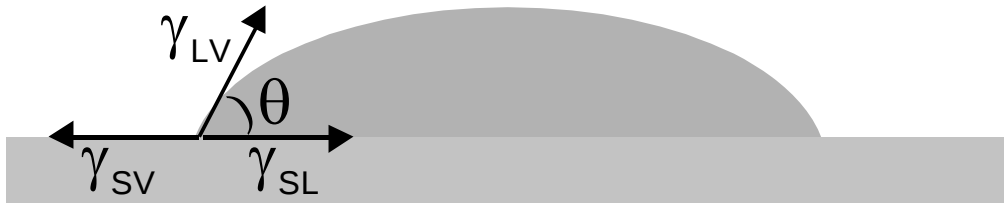
Figura 11 - Ângulo de Contato (Adaptado de INONE, P. C. et al, 2003).
