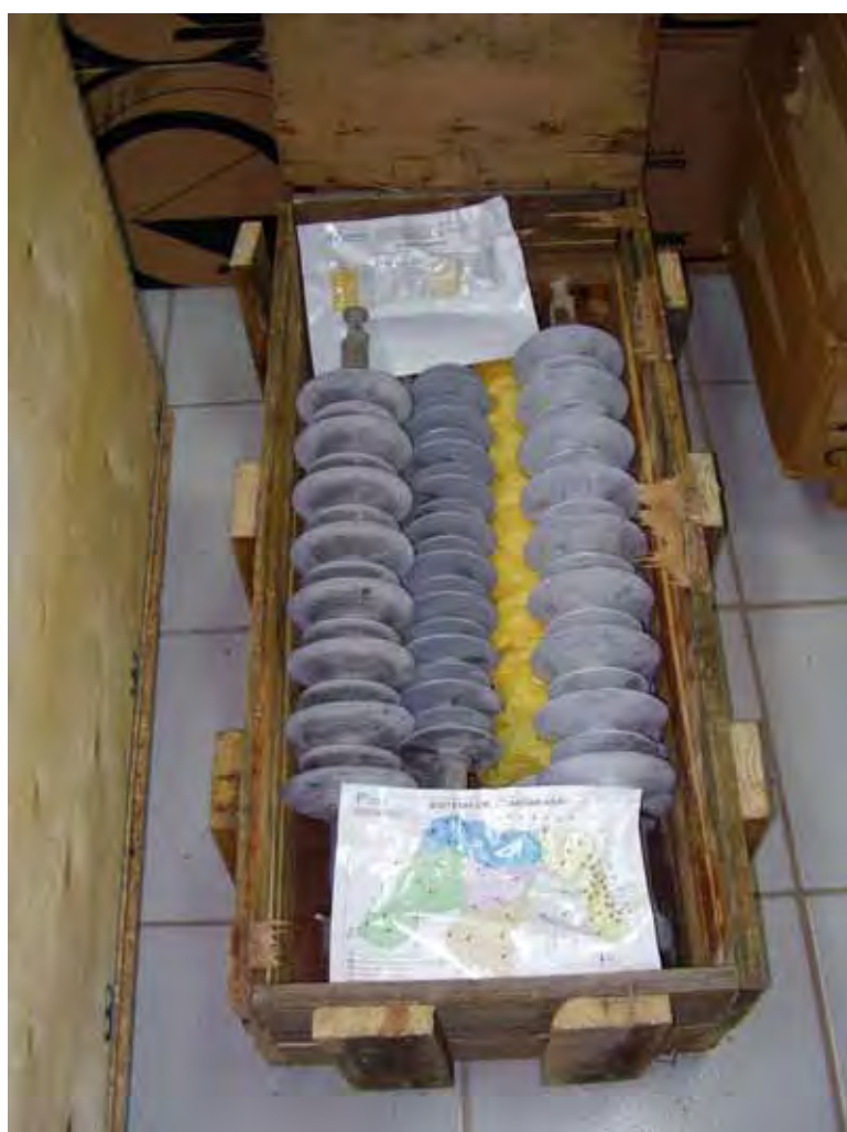
Figura 18 – Isoladores poluídos provenientes de áreas com histórico de desligamento
