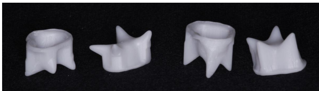
Figura 3- Coroas de zircônia com retenções para posterior embutimento em resina acrílica.
