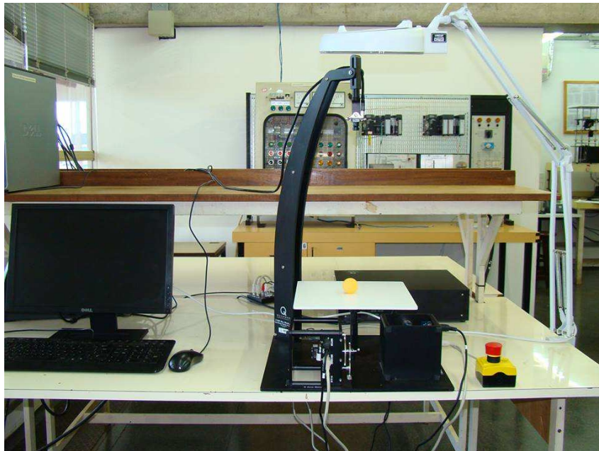
Figura 19 - Sistema ball balancer Quanser ® pertencente ao Laboratório de Pesquisa em Controle da Unesp de Ilha Solteira (LPC - FEIS - UNESP).
