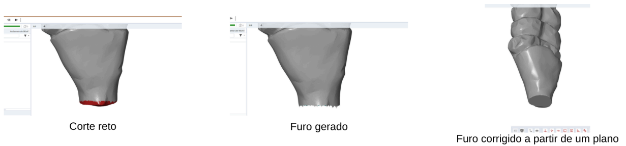
Figura 12: Adaptação para impressão. (Fonte: Acervo pessoal, 2022).
