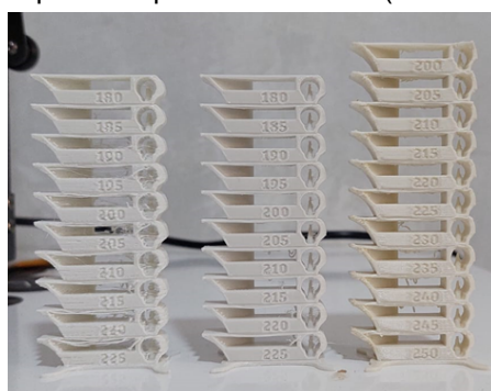
Figura 15: Torre de temperatura para PLA e ABS. (Fonte: Acervo pessoal, 2022).
