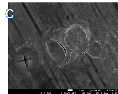
Figura 22 – Imagens obtidas por SEM das superfícies do aço após os testes de câmara úmida durante 1 dia na presença e ausência dos VCI. A) antes do experimento; B) ausência de VCI; presença de C) CHA; D) ETA; E) CRO; F) DCHA; G) PCA; H) TEA e I) PRO.
